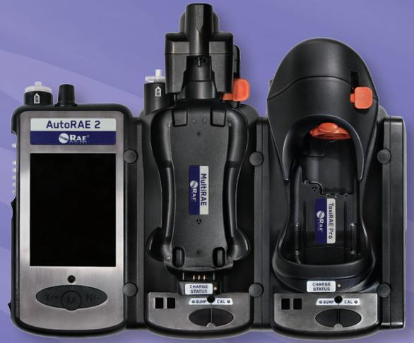
Le système automatique de test et d'étalonnage AutoRAE 2 pour les détecteurs portables de RAE Systems permet de répondre aux exigences d'étalonnage et de test des gaz grâce à un seul bouton. Il suffit de poser le détecteur sur le socle et le système effectue l'étalonnage, les tests et le rechargement.
