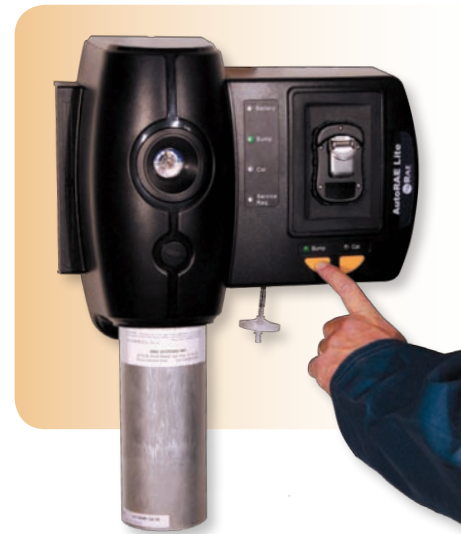
Funktionstest des ToxiRAE 3 mit der Funktionstest- und Kalibrierstation "AutoRAE Lite"
