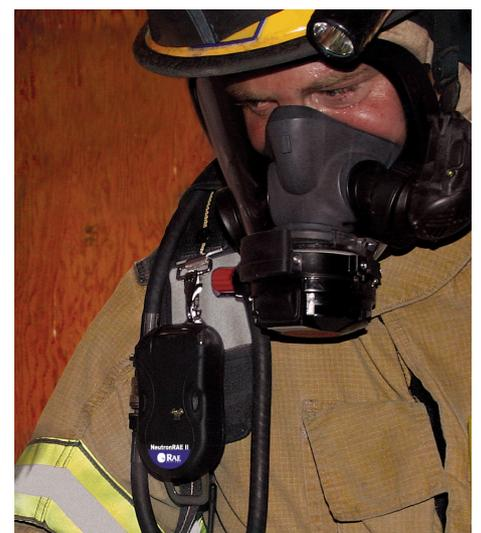
Einsatzkräfte verwenden RAE Systems NeutronRAE II für akustische und optische Alarmer bei Vorhandensein einer Strahlungsgefahr und zur Information über die Gesamtdosisbelastung mit Gammastrahlung.
