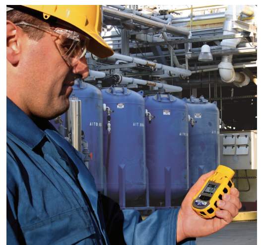
Überwachung der Belastung der Arbeiter mit ToxiRAE Pro PID in einem PVC-Werk
