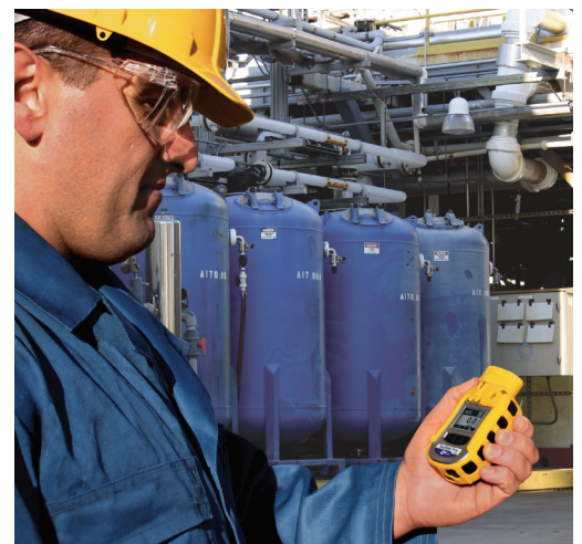
Surveillance de l'exposition des travailleurs avec le ToxiRAE Pro PID sur un site de production de PVC
