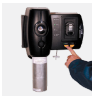
Funktionstest des ToxiRAE 3 mit der Funktionstest- und Kalibrierstation des AutoRAE Lite
