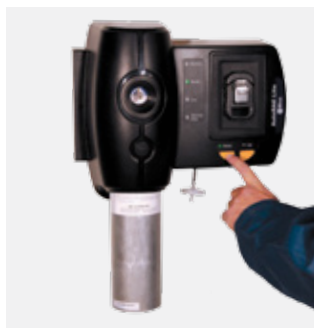
Test fonctionnel du ToxiRAE 3 avec la station d'étalonnage et de tests AutoRAE Lite
