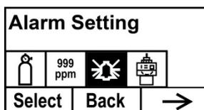
1. Sélectionnez High Alarm (Alarme de concentration haute) ou Low Alarm (Alarme de concentration basse) en appuyant sur [-].
