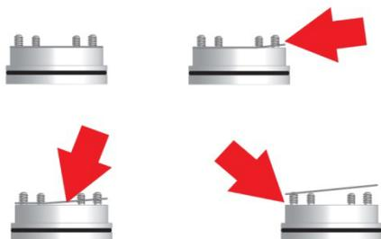
7. Une fois que l'écran UV en Teflon est suffisamment séparé du module du capteur pour vous permettre de le saisir, sortez-le des quatre « pattes » de contact, puis jetez-le.
