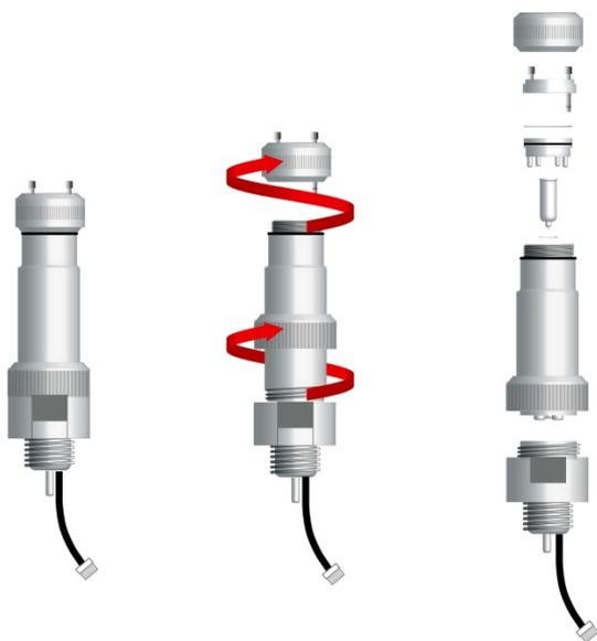
**Pour défaire facilement le DigiPID de sa base, desserrez l'écrou de fixation.**
