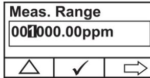
1. Appuyez sur [+] pour augmenter le chiffre entre 0 et 9 (le système revient automatiquement sur 0 après 9).
