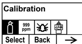
Appuyez sur [+] pour sélectionner Calibration (Étalonnage). Vous pouvez également appuyer sur [MODE] pour revenir en arrière ou sur [-] pour passer au menu suivant.
