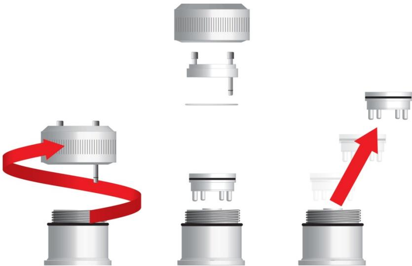
2. Remplacez le module du capteur par une pièce neuve après l'avoir retiré (un module du capteur de rechange est inclus avec l'unité).
