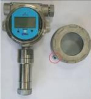
1. Desserrez le boulon de fixation avant de dévisser le couvercle du boîtier. Dévissez le couvercle du corps du boîtier en le tournant dans le sens inverse des aiguilles d'une montre. (Lors de l'expédition, l'un des orifices du conduit est couvert par la prise à tête hexagonale fournie. L'autre conduit est prévu pour la connexion des fils.)
