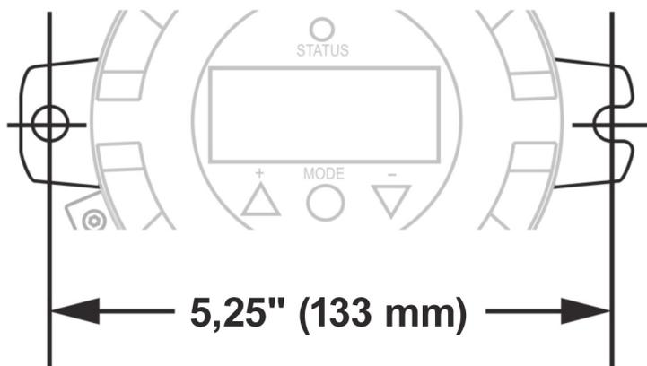
Le RAEGuard 2 PID peut être directement monté sur un mur, mais également sur un tube.
