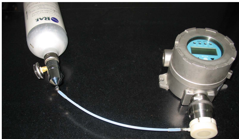
RAEGuard S verbunden mit Gaszylinder mit einem Kalibrieradapter
