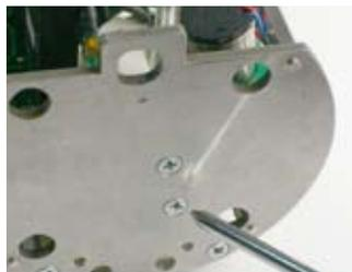
4. Halten Sie die Pumpe und entfernen Sie die beiden Phillips-Schrauben aus dem Sockel der Instrumentenbaugruppe.
