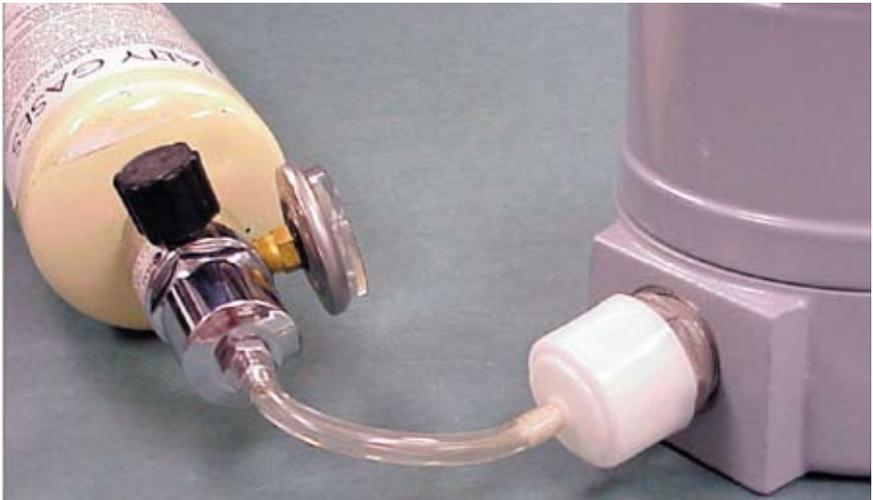
**RAEGuard PID, mit Kalibrierungsadapter an Gasflasche angeschlossen.**
