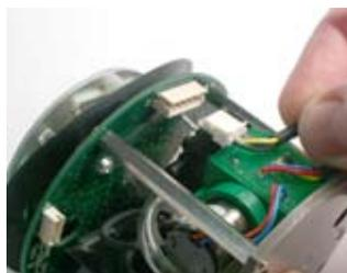
2. Trennen Sie den weißen 5-kabeligen Konnektor, durch den die Pumpe mit der Leiterplatte verbunden wird.
