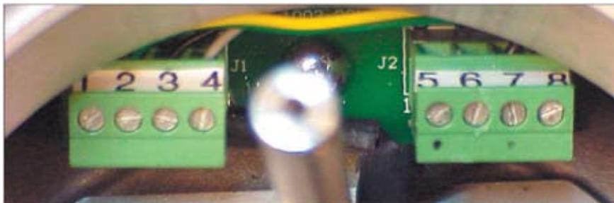
2. Stecken Sie die Kabel durch die Kabelöffnung(en) des RAEGuard PID und schließen Sie die Kabel an die entsprechenden Pin-Nummern des Anschlussblocks an.
