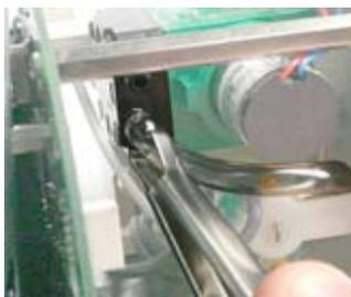
3. Entfernen Sie die Röhre vom linken Einlass an der Pumpe. Ein kleiner Schraubenzieher ist unter Umständen hilfreich beim Entfernen des Schlauches vom Konnektor. Sie können auch eine IC-Zange oder eine Flachrundzange verwenden.
