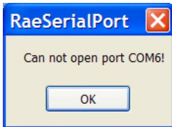
Überprüfen Sie den ausgewählten COM-Anschluss. Vergewissern Sie sich zudem, dass das USB-Kabel mit dem AutoRAE Lite verbunden ist und dass der AutoRAE Lite eingeschaltet ist.
