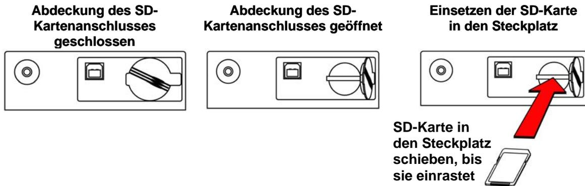
**Einsetzen einer SD-Karte.** Schieben Sie die SD-Karte in den Steckplatz. Die abgeschrägte Kante muss nach rechts weisen. Die Karte muss im Steckplatz einrasten (Klickton).
