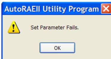
Überprüfen Sie die Parametereinstellungen und die Kabelverbindungen, und wiederholen Sie den Vorgang.
